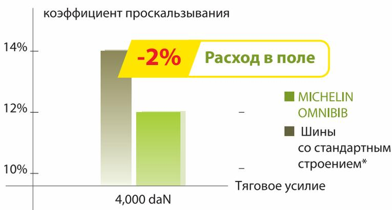
Коэффициент проскальзывания трактора с загрузкой 3.85 тонн с шинами MICHELIN OMNIBIB составляет 12% по сравнению с шинами со стандартным строением
